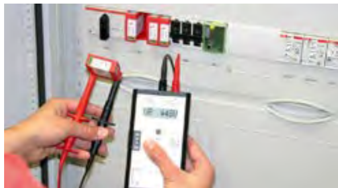
Zur Prüfung der Ansprechspannung von Überspannungs-Ableitern. Anschluss des Prüflings über beiliegende Prüfleitungen oder spezielle Prüfadapter.
