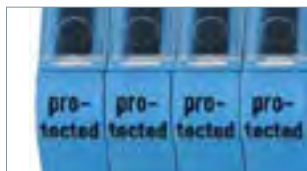
Kennzeichnung der geschützten Seite – minimiert Verdrahtungsfehler.
