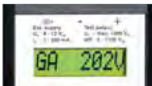
Anzeige der gemessenen Ansprechspannung.
