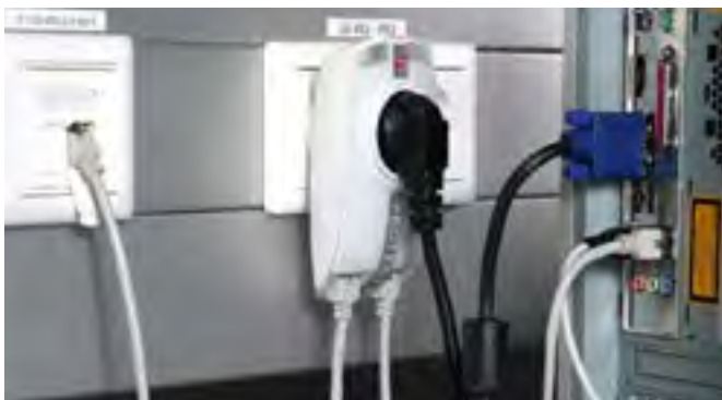
Kombinierter Überspannungsschutz-Adapter zum Einstecken in Schutzkontakt-Steckdosen, mit optischer Betriebs- und Defektanzeige.
