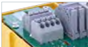
Push-In-Klemmen für den werkzeuglosen Schnellanschluss (DBX TC B 180).
