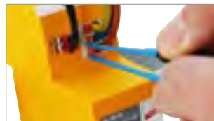
Integrierte Prüföffnungen für Tests im Signalkreis mittels Prüfstifte.
