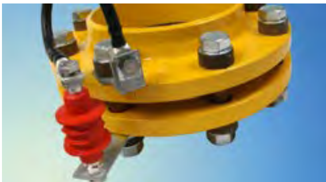
ATEX und IECEx-zertifizierte Trennfunknstrecke für den Blitzschutz-Potentialausgleich nach DIN EN 62305 / VDE 0185 mit tiefer Ansprechspannung.
