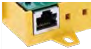
RJ45 Buchse am Ausgang für den direkten Anschluss am Router (DBX TC B 180).
