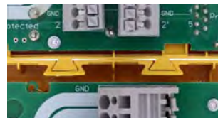
Aneinanderreihung mehrerer Geräte durch Stecktechnik der Gehäuse möglich (DBX TC B 180).
