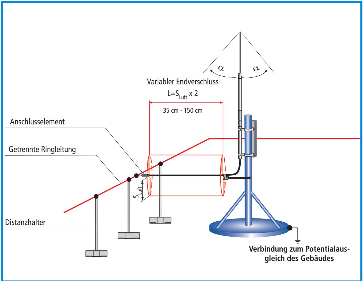
**Bild 19** Variabler Endverschluss mit PA-Element
