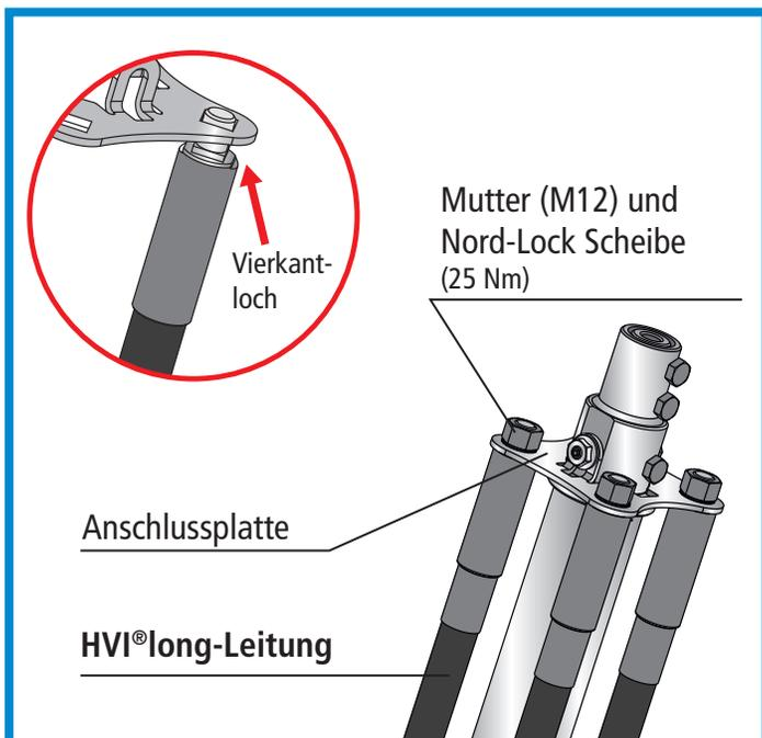
**Bild 9** Montage Außenverlegung - Schritt 3
