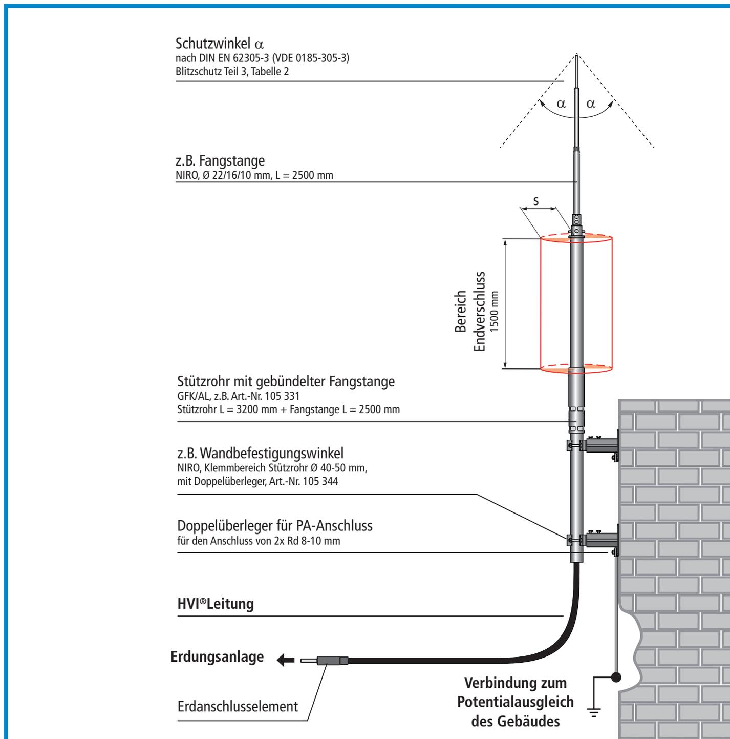
Bild 15 Getrennte Fangeinrichtung mit HVI®Leitung und Wandhalterung
