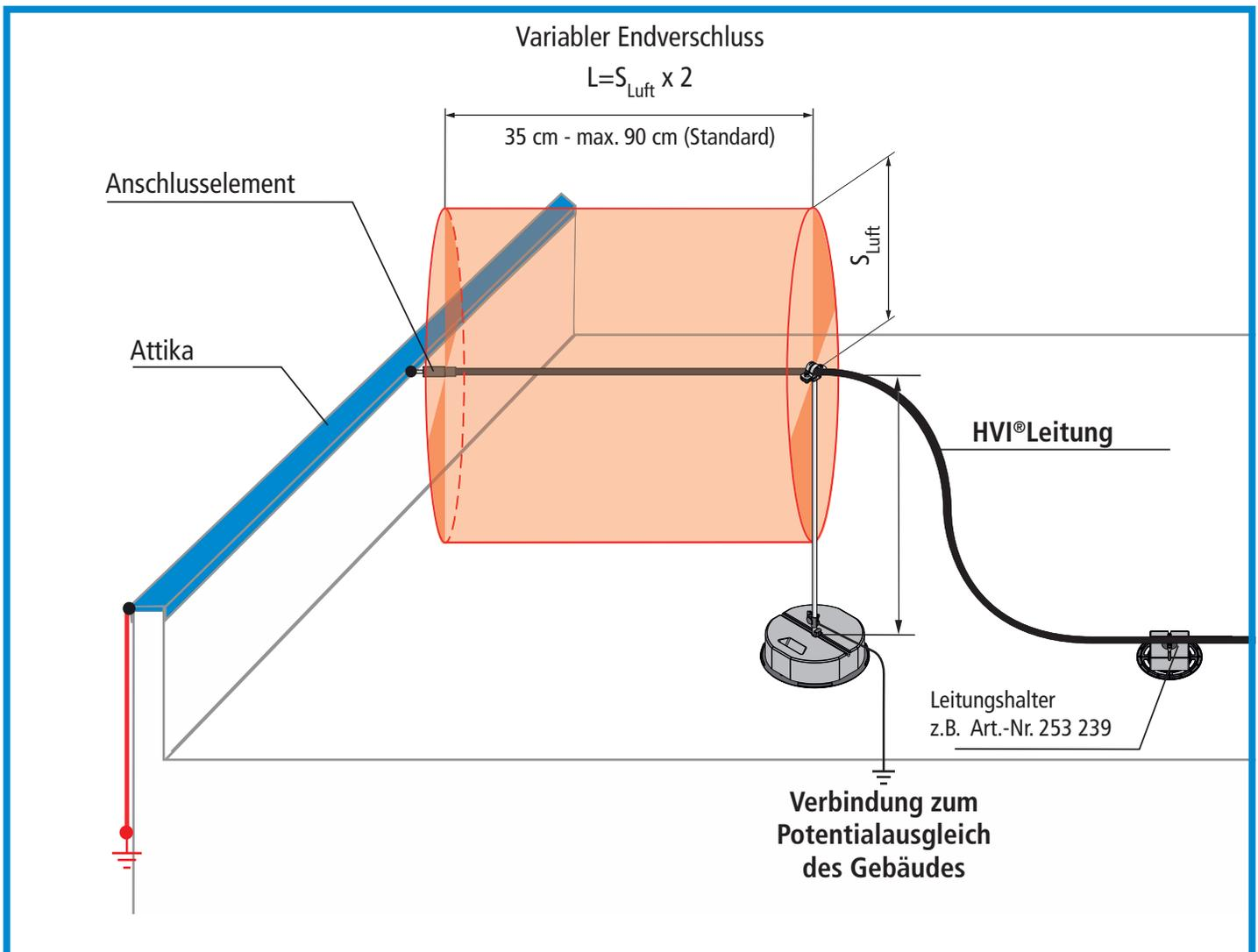
**Bild 20** Variabler Endverschluss an "Attika" mit Distanzhalter (Art.-Nr. 105 275)
