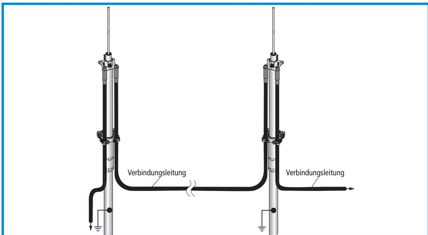
**Bild 12** Verbindungsleitung zwischen den Stützrohren
