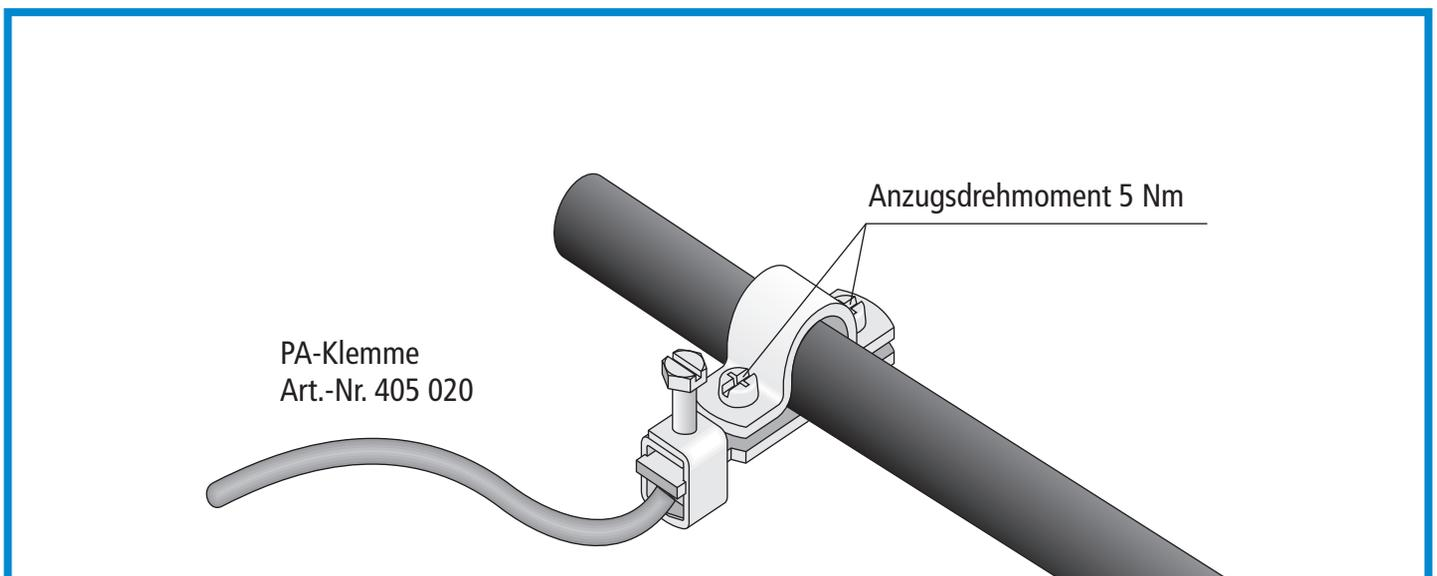
**Bild 24** Anschluss Potentialausgleich
