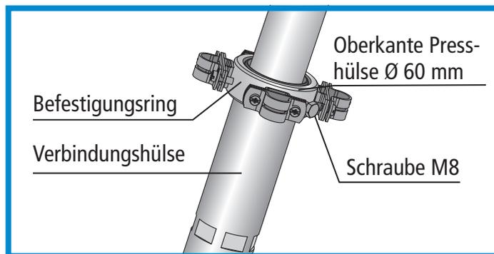
**Bild 7** Montage Außenverlegung - Schritt 1
