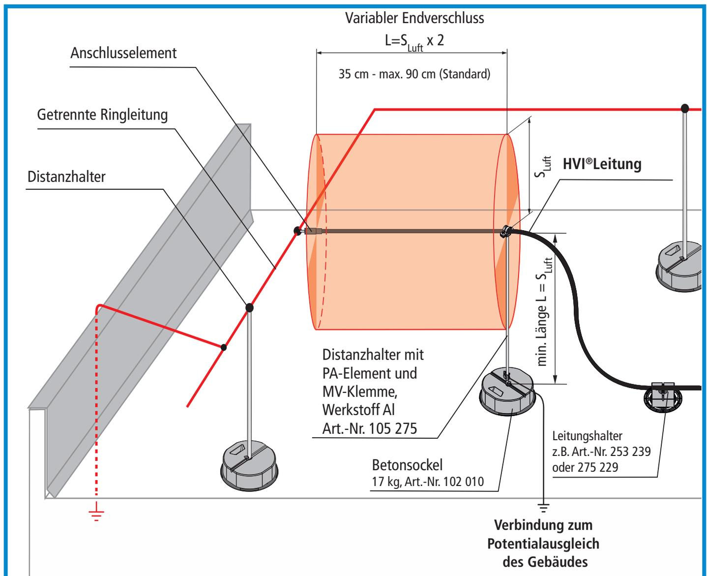
**Bild 18** Variabler Endverschluss mit Distanzhalter (Art.-Nr 105 275)
