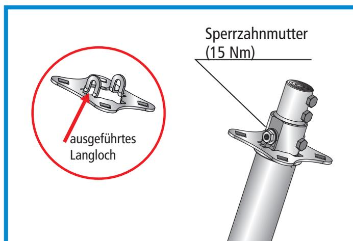
**Bild 8** Montage Außenverlegung - Schritt 2
