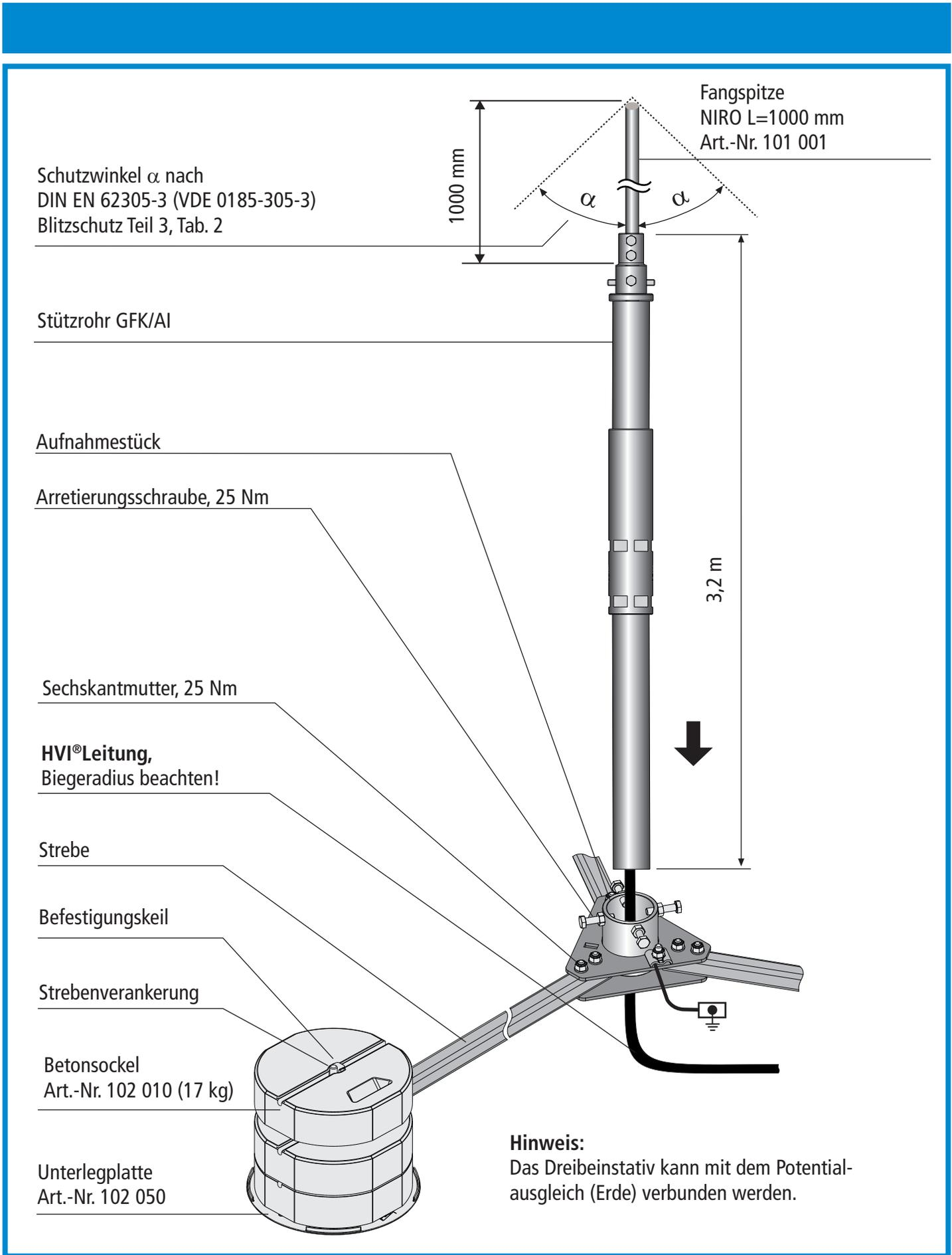
Bild 23 HVI®Leitung im Stützrohr (Länge 3,2 m) errichtet im Dreibeinstantiv Art.-Nr. 105 350
