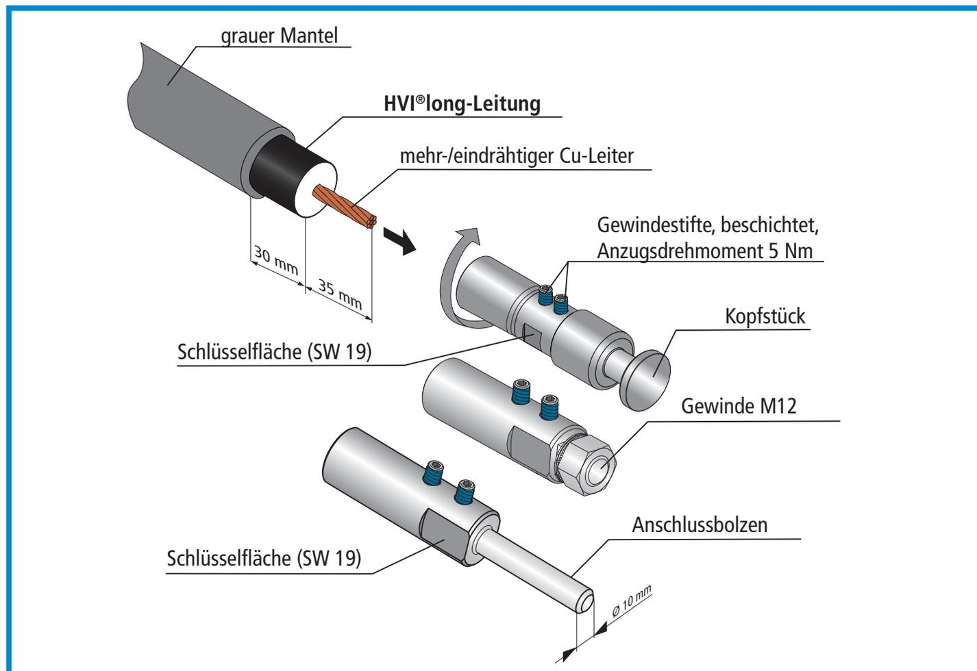
**Bild 3** Montage des Kopfstückes bzw. Anschlusselementes
