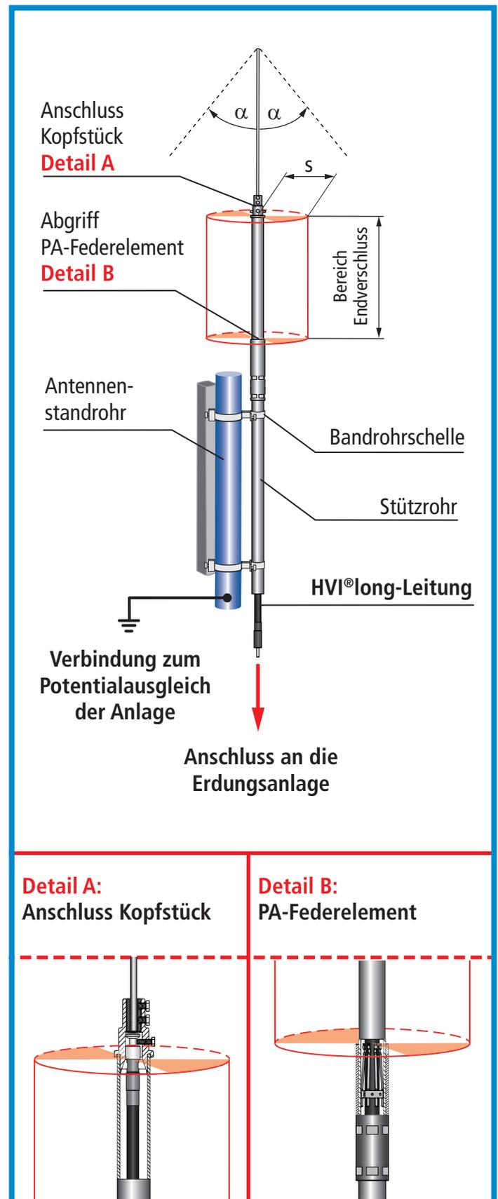
Bild 13 Bereich des Endverschlusses im Stützrohr
