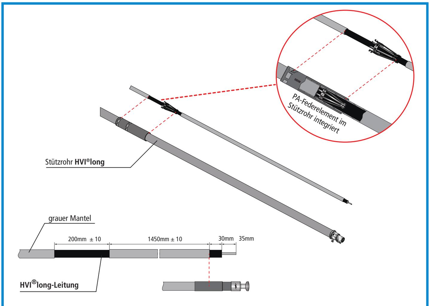
**Bild 5** Verlegung im Stützrohr
