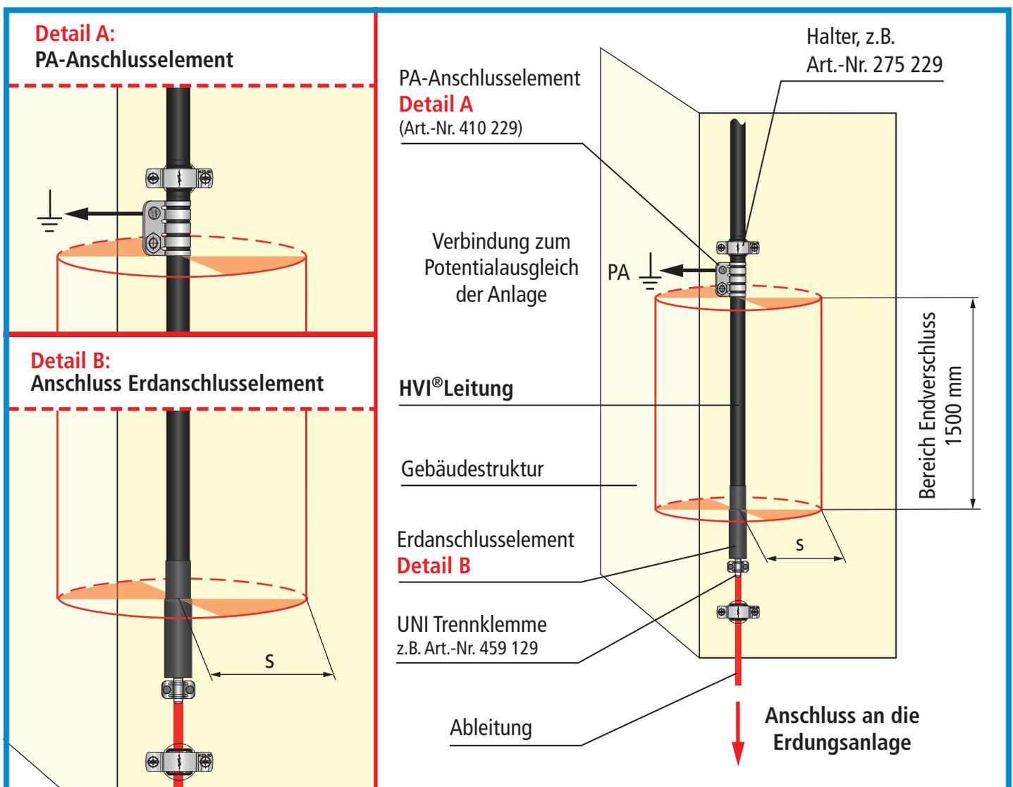
**Bild 21** Bereich des Endverschlusses an einer Gebäudestruktur
