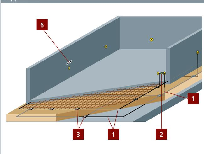
Fundamenterder nach DIN 18014 ohne Blitzschutzsystem;
