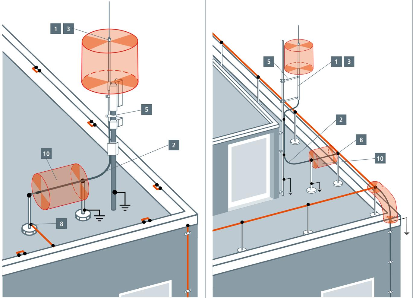
Montage HVI®Leitung an einer explosionsgefährdeten Anlage
