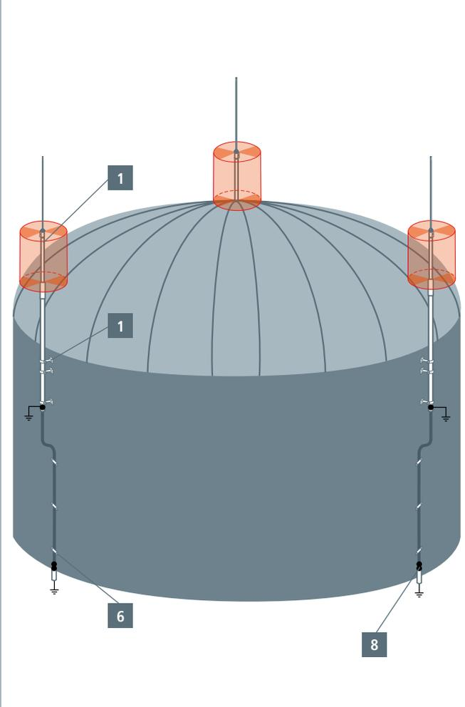
Schutz eines Gebäudes mit weicher Bedachung mit HVI®Leitung
