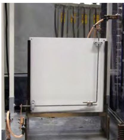
**Bild 5:** Auf Isolierplatte befestigter Prüfling (MV-Klemme) für Test im Stoßstromlabor.
