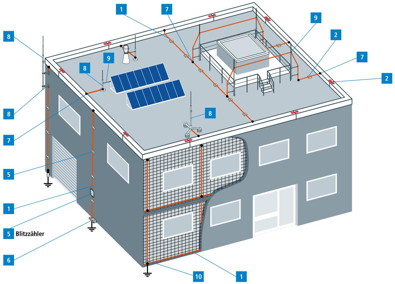
Schutz Antennenanlage bei vorhandenen LPS-System nach DIN EN 60728-11 (VDE 0855-1)
