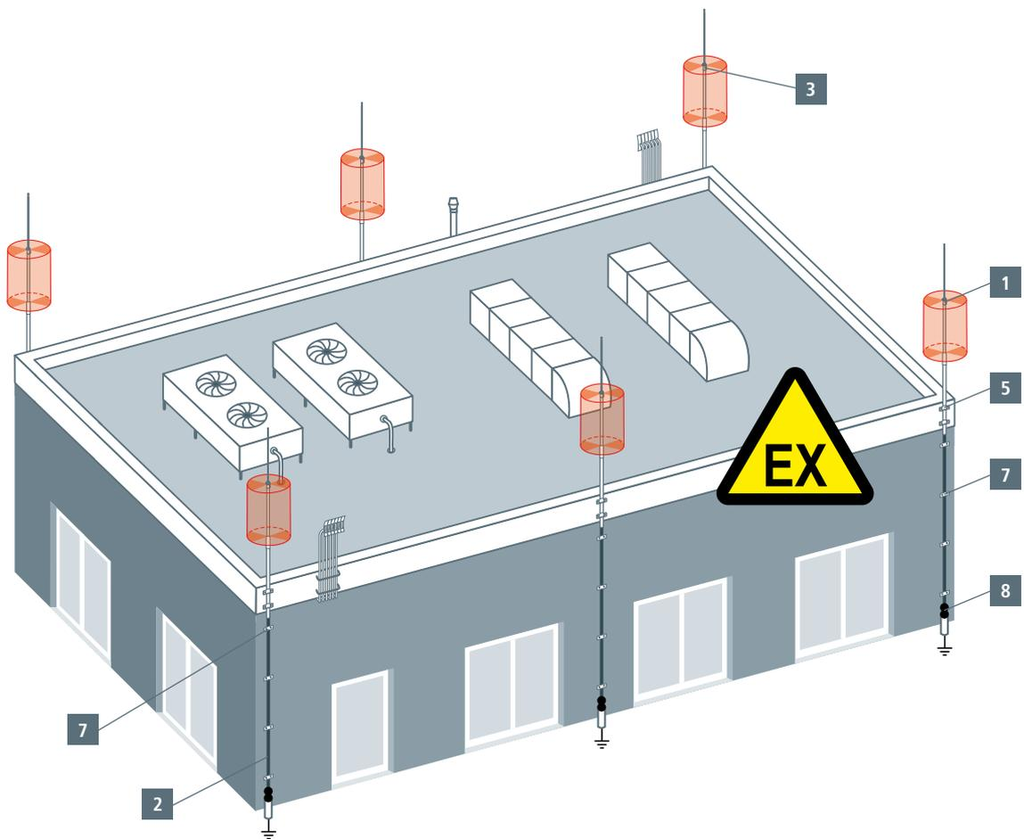
Schutz eines Gasbehälters mit HVI®Leitung
