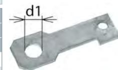
**EXFS 100: Anschlussleitung Cu 25 mm<sup>2</sup>** Anschlussleitung für EXFS 100; 2 Kabelschuhe Ø10,5 mm, Werkstoff Cu/gal Sn, Schraube, Mutter und Federring.
