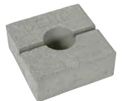
**Grundplatte** Grundplatte zur Aufnahme (Steckbuchse) des Distanzstabs (Art.-Nr. 253 315, 253 325) sowie Leitungshalter (Art.-Nr. 253 289) und zum Schutz der Dachbahnen unter dem Betonstein (Art.-Nr. 253 301).
