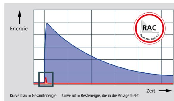
\* Als Restenergie wird der Wert einer Überspannung bezeichnet, die in das Gebäude eintritt, vom Überspannungs-Ableiter absorbiert wird und an die nachgelagerten Endgeräte bzw. Systeme weitergegeben wird.
