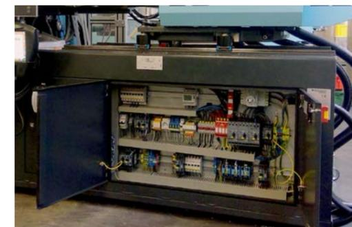
Zusätzlicher Schutz ergibt sich durch die Kombination mit dem dazugehörigen inneren Blitzschutz. Ableiter wie ACI- oder CI-Ableiter schaffen Sicherheit für die Energieversorgung und zugleich wertvollen Platz. Da sie vorsicherungsfrei sind, werden Fehler bei der Dimensionierung einer vorgelagerten Gerätesicherung automatisch ausgeschlossen. Zudem werden geforderte Anschlusslängen leichter eingehalten.
