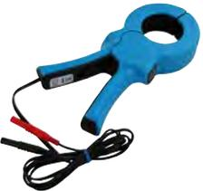
**Zangenstromwandler METREL A1019 (Generatorzange 1000A / 1A mit Anschlussbuchsen)**
