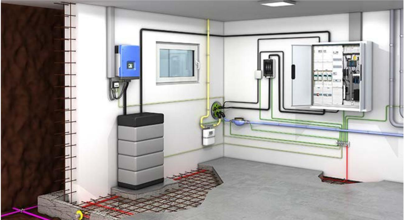
> Bild 9: Niederohmige Anbindung von Betriebsmitteln an Haupterdungsschiene durch Potentialausgleichsleiter
