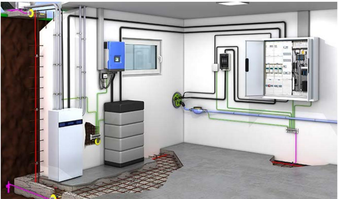
> Bild 8: Niederohmigkeitsanbindung von Betriebsmitteln in den Potentialausgleich durch Nutzung der kombinierten Potentialausgleichsanlage als Potentialausgleichsleiter
