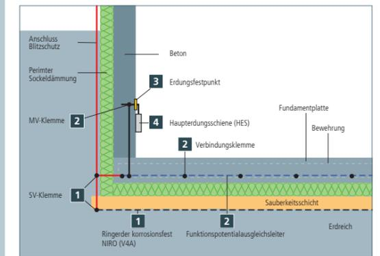
Anordnung des Fundamenterders bei einer geschlossenen Bodenplatte (vollisoliert) entsprechend DIN 18014
