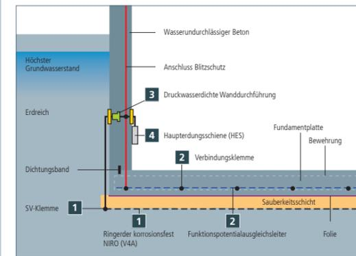
Anordnung eines Fundamenterders bei einer „Weißen Wanne“ entsprechend DIN 18014
