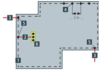
**Anschlusssteil 2** zur **Haupterdungsschiene 6** und **Anschlusssteil 3** für Äußeren Blitzschutz mit **SV-Klemme 5**
