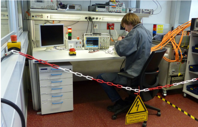
Abb. 9 Fachkundige Person Hochvolt (FHV) bei Arbeiten an HV-Komponenten in der Entwicklung
