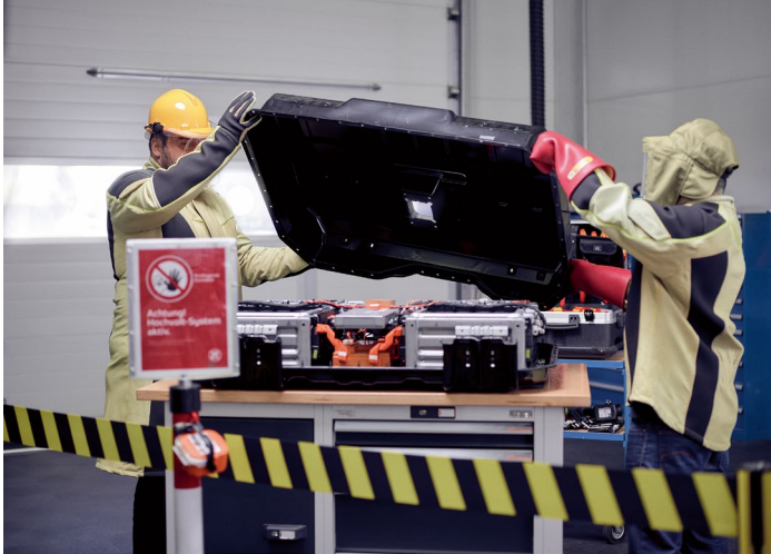
Abb. 14 Beispiel für das Absichern des Arbeitsbereichs bei Arbeiten an unter Spannung stehenden HV-Komponenten
