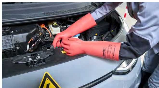
Arbeiten an einem E-Fahrzeug mit isolierenden Handschuhen.
