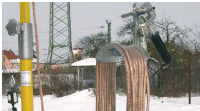
Erdungsspieß mit aufgewickelter Erdungsleitung.
