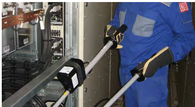
Gleichspannungsprüfer PHE/G II für Gleichstromzwischenkreise (ICE-Triebkopf).
