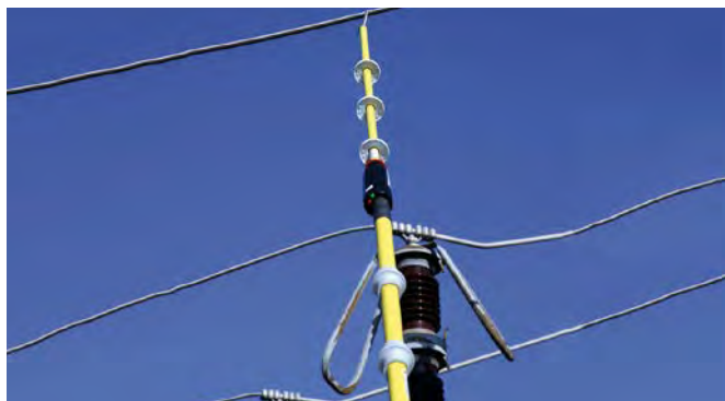
Spannungsprüfer PHE III an einer Freiluftstation 110 kV.
