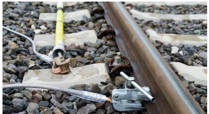
Schienenanschlussklemme am Schienenprofil montiert.
