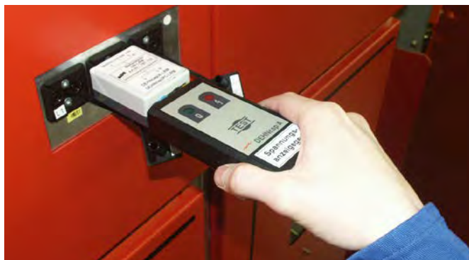
Eigenprüfung des Spannungsanzeigergerätes DEHNcap/A.
