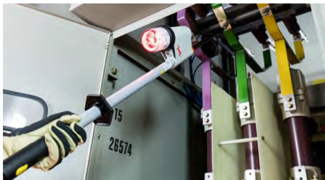
Spannungsprüfer PHE4 mit optischer und akustischer Anzeige.
