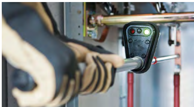
Spannungsprüfer PHE mit optischer Anzeige.
