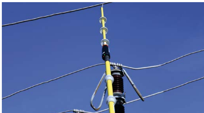
Spannungsprüfer PHE III an einer Freiluftstation 110 kV.
