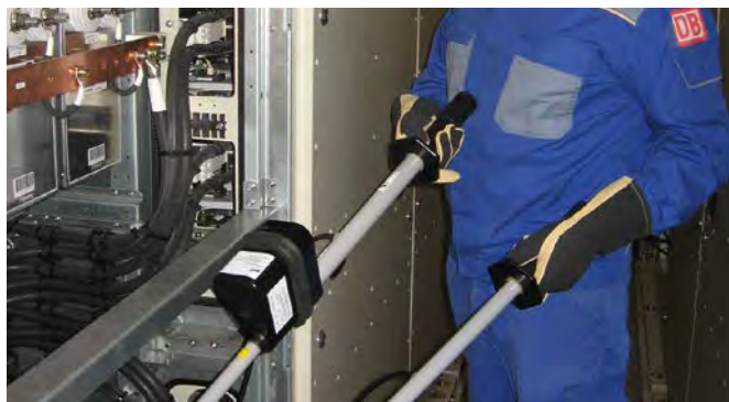
Gleichspannungsprüfer PHE/G II für Gleichstromzwischenkreise (ICE-Triebkopf).
