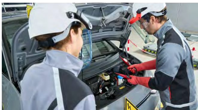
Prüfung der hohen DC-Spannung eines HV-Elektrofahrzeuges.
