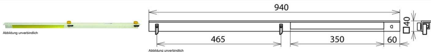
Lichtsensorhalteschiene zur Montage an der Profilschiene im oberen Bereich des Niederspannungsgerüsts mittels Rändelmutter
