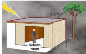
Bild 1: Schutzraum einer Schutzhütte mit Blitzschutzsystem außerhalb der Hütte sind im Allgemeinen nicht geschützt.
