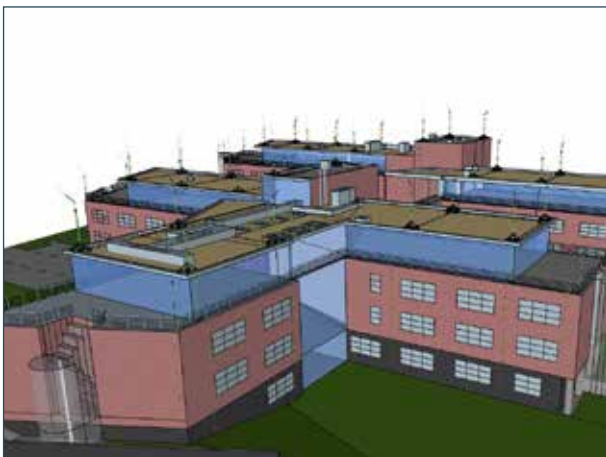
Positionierung der Fangeinrichtungen
