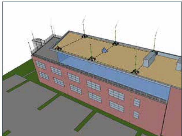
Positionierung der Fangeinrichtungen
