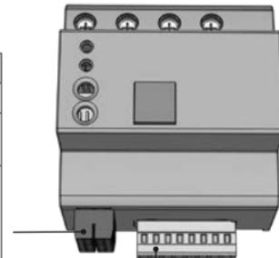
Zur Entriegelung der Push-In-Anschlüsse wird ein Schlitz-Schraubendreher ( $\leq 2,5$  mm) benötigt
