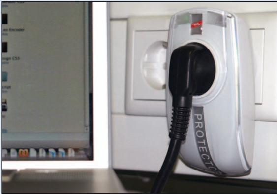
Bild 4 Universelles Überspannungsschutzgerät (DATA-Protector) zum Schutz der Netz- und Datenleitungen eines Arbeitsplatzes
