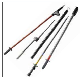
Alte Spannungsprüfer ohne roten Ring, ohne Verlängerungsteil – Gefährdung durch Fehlanzeigen, elektrischen Schlag oder Störlichtbogenbildung
